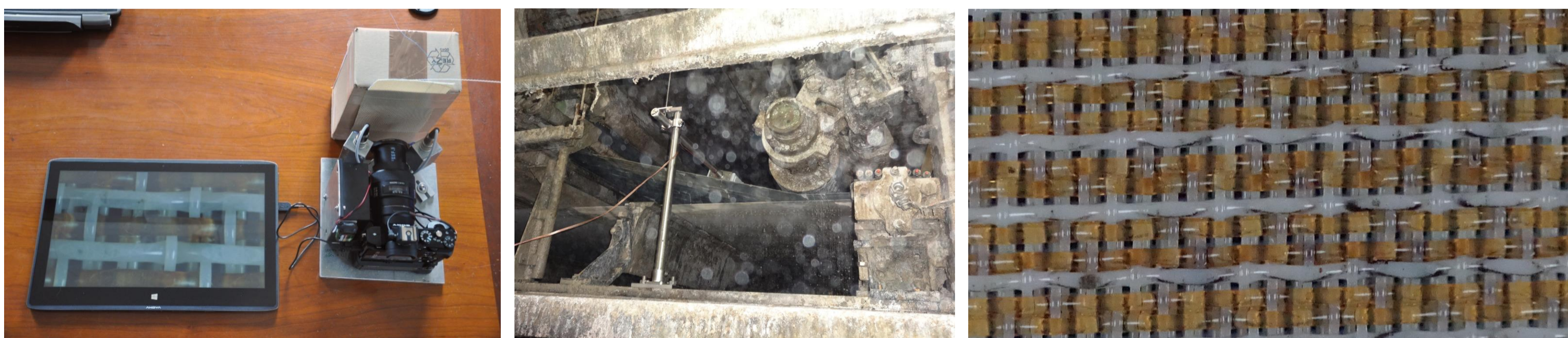
Versuchsaufbau im Labor (a) / Einbausituation in einer Papiermaschine (b) / Ergebnis bei ca. 1600m/min
