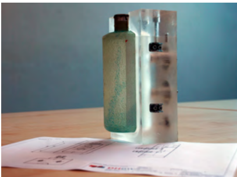
■ Der Druckbehälter vor der Entnahme aus der Versuchsform
